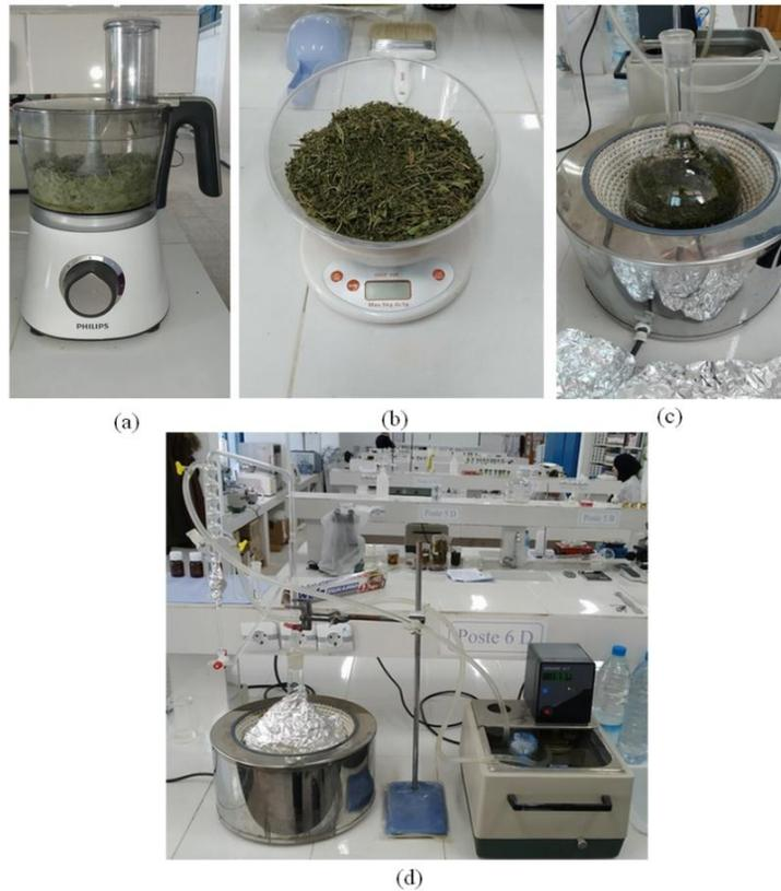
Figure 16: Extraction de l'HE d'*E.globulus* par Hydrodistillation (a) broyage des feuilles ; (b) pesée des feuilles broyées ; (c) mélange des feuilles et de l'eau distillée dans un ballon en verre ; (d) extraction de l'HE d'*E.globulus* à l'aide du Clevenger. (photos personnelles, 2020).
