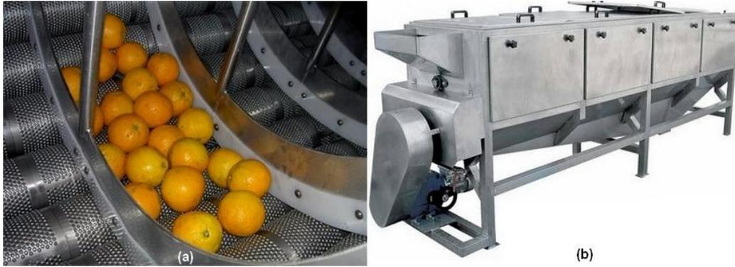
Figure 6 : Machine à expression à froid (a) grattage des épicarpes d'agrumes (tirée de : <http://alambic-inox.com/distillation-agrumes/distillation-agrumes-huiles-essentielles.html> consulté le 30/03/2020 à 13:06) (modifié)
